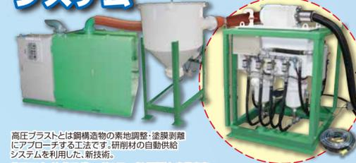
高圧プラストとは鋼構造物の素地調整・塗膜剥離にアプローチする工法です。研削材の自動供給システムを利用した、新技術。
